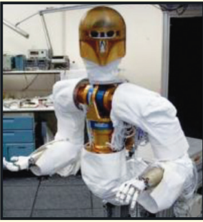
Εικόνα 3.26. Ο «ρομποναύτης» της NASA κατασκευάστηκε για την συντήρηση του διαστημικού τηλεσκοπίου HUBBLE.
